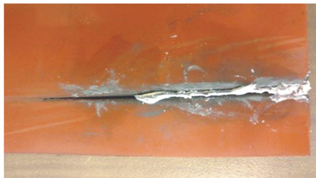
图：早期尝试利用3D打印技术在硅塑料基板上打印铝合金线，卡尔顿大学正开发这种3D打印机原型
